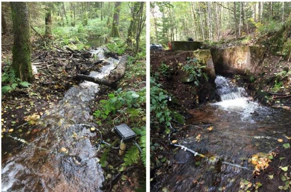
*Exemple d'antenne RFID fixe placée dans un cours d'eau à lamproie en aval d'un ouvrage*
