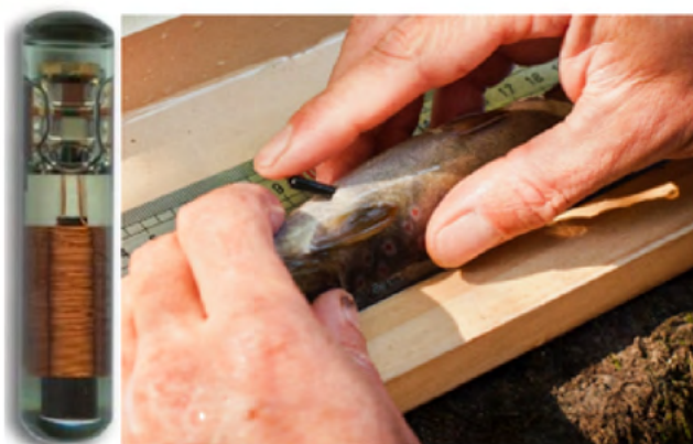
La télémétrie passive (RFID) sera utilisée avec marquage de truite et galets
